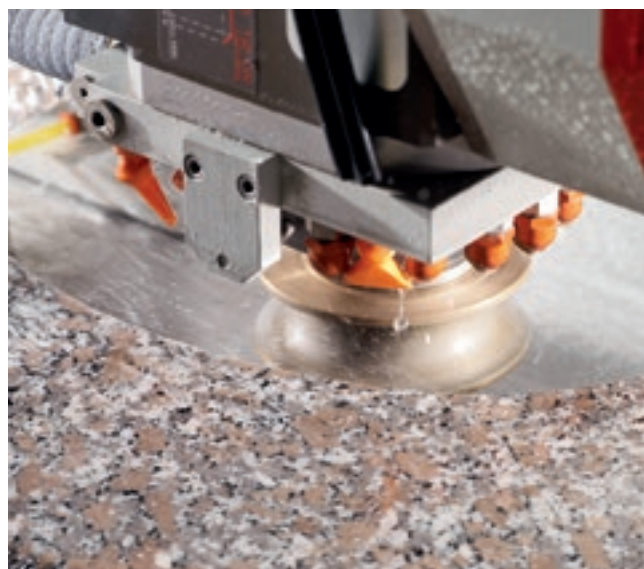
Шлифование и полирование.
