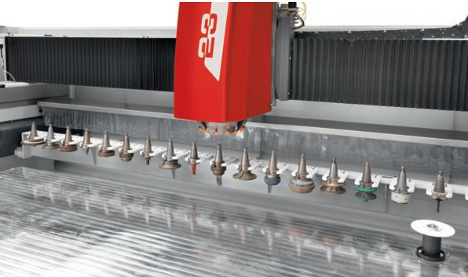
Changement d'outil arrière avec carter de protection contre les résidus de façonnage pour les cônes à 18 positions et chargement automatique de l'outil avec le groupe opérateur.
